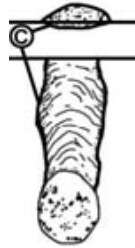
Arc trop long
