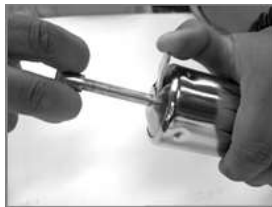
Appuyer sur la gâchette pour actionner le plongeur
