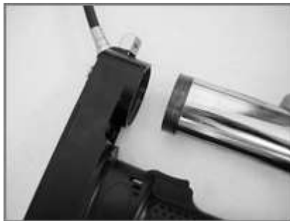
Pour retirer la cartouche tourner le porte-tube vers la gauche. Tourner vers la droite pour serrer
