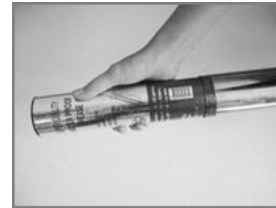
Installation d'une Cartouche de Graisse
