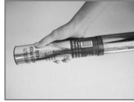
Installation d'une Cartouche de Graisse
