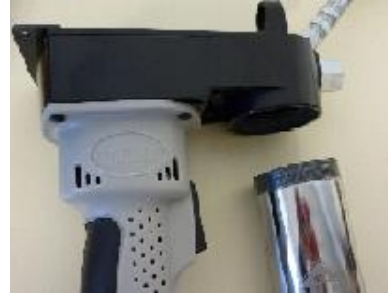
Pour retirer la cartouche tourner le porte-tube vers la gauche. Tourner vers la droite pour serrer
